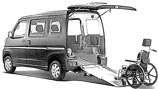
購入予定の「ダイハツ アトレーワゴン」 スローパーSAⅢ (リヤシートレス+補助シート) 出典：ダイハツホームページ
