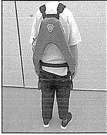
マッスルスーツ 装着型の作業支援ロボット。介助負担の軽減、腰痛予防として活躍。
